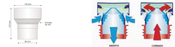
**Funcionamiento:** Las válvulas se abren y facilitan la entrada de aire exterior cuando se produce una depresión en la instalación debido a la descarga. Entonces equilibra la presión y los aparatos sanitarios no se desifonan. Cuando finaliza la descarga la válvula se cierra por su propio peso, evitando la fuga de malos olores procedentes de la instalación.
