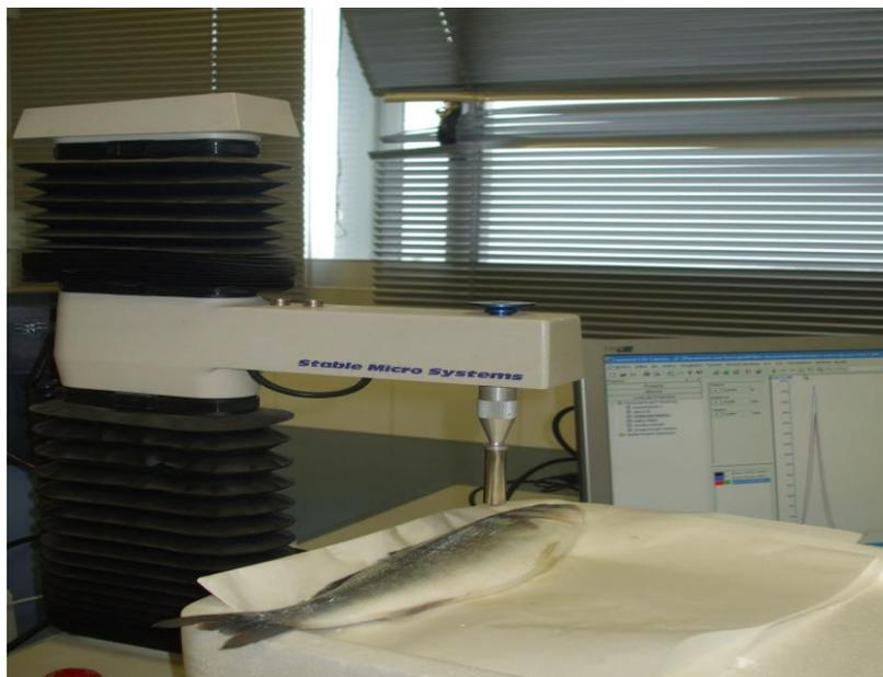
Figura 17: Texturómetro Stable Micro Systems TA.XT2 (Surrey, Inglaterra) (Fuente propia)
