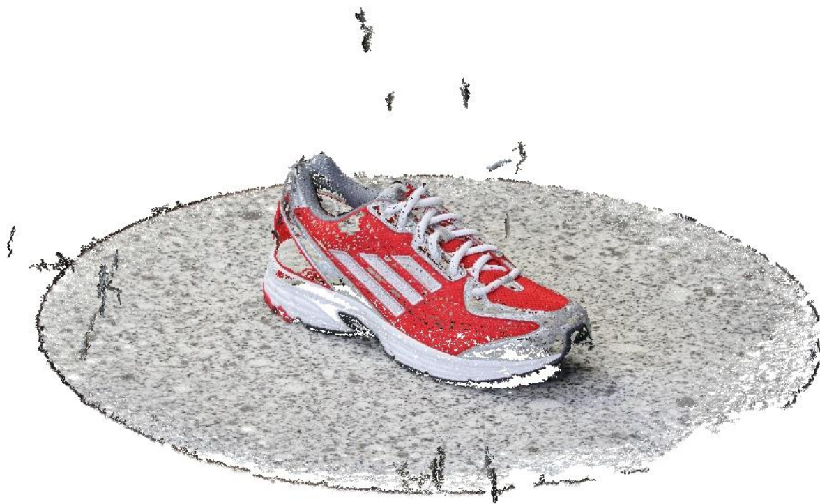
Figura 30. Resultado de la reconstrucción densa de la nube de puntos
