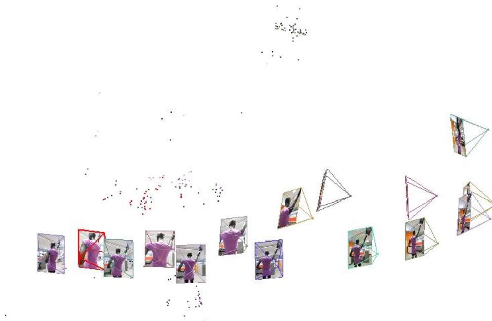
Figura 23. Primera reconstrucción de puntos 3D
