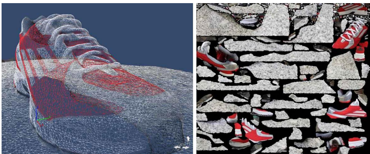
Figura 6. Mapa de textura (izquierda) y mallado (derecha) del modelo 3D
