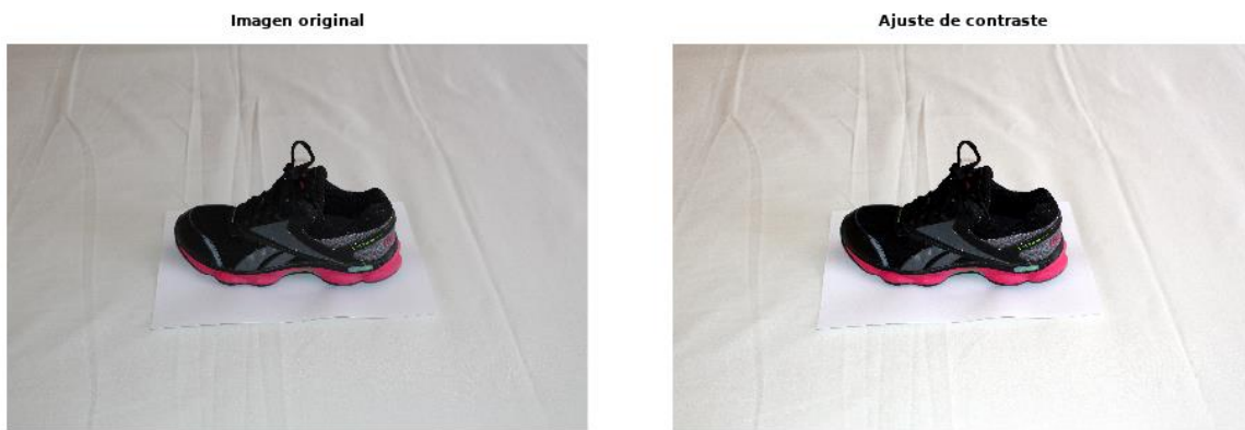
Figura 40. Ejemplo de preprocesamiento de la imagen por ajuste de contraste
