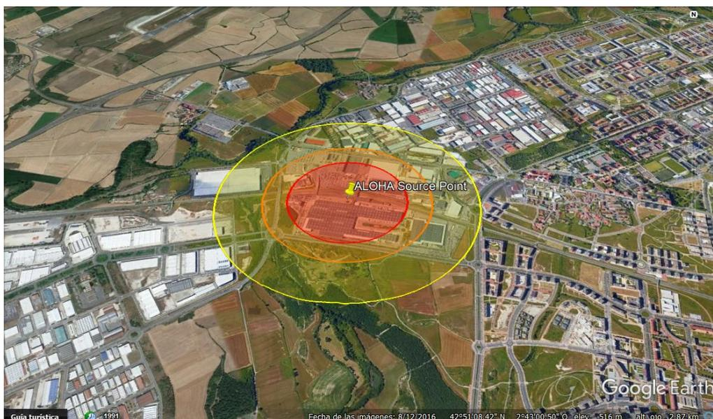
Ilustración 40 Huella de exportación con zonas de afectación por BLEVE producida por gasolina en la zona de descarga del almacenamiento de fluidos de Mercedes Benz Vitoria. Fuente Google Earth y ALOHA. Elaboración propia.
