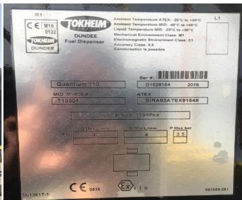
Ilustración 22 Etiqueta homologación ATEX del surtidor. Elaboración propia.
