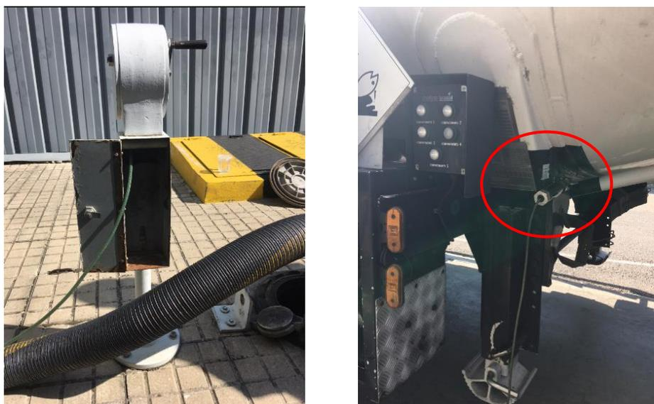
Ilustración 15 Conexión de seguridad para toma de tierra durante proceso de descarga. Elaboración propia
