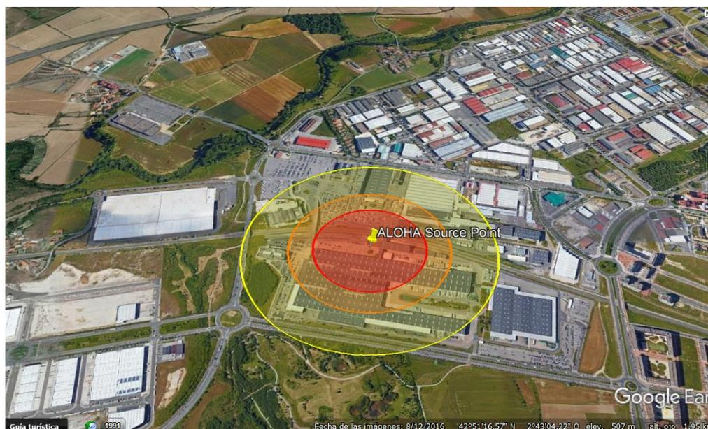
Ilustración 49 Huella de exportación con zonas de afectación por BLEVE producida por etanol en la zona de descarga del almacenamiento de fluidos de Mercedes Benz Vitoria.
