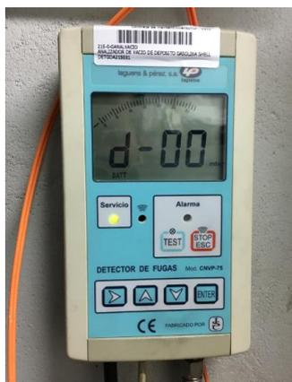
Ilustración 16 Detector fugas depósito gasolina.
