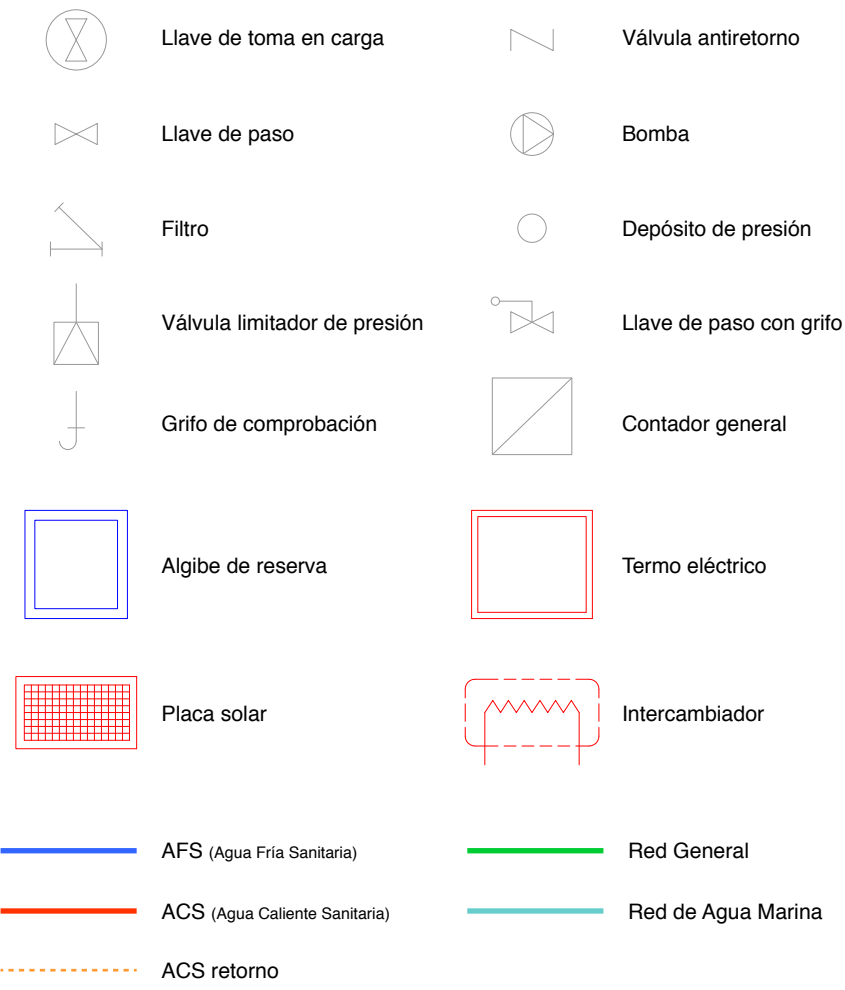
// INSTALACIÓN / Leyenda y cuarto de instalaciones
