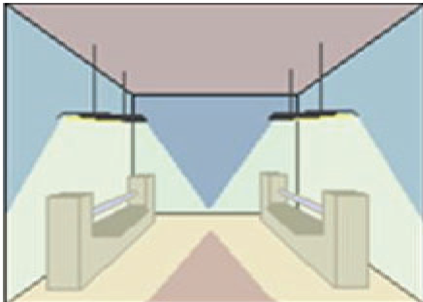
Ilustración 2. Alumbrado general localizado. Elaboración propia.
