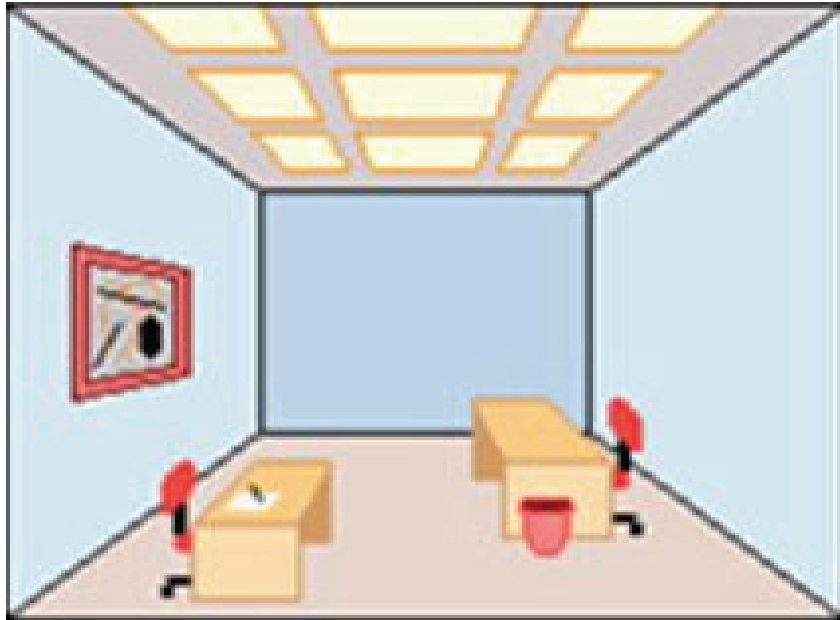
Ilustración 1. Alumbrado general. Elaboración propia.
