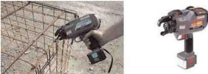
Figura 68 - Herramienta eléctrica para el atado de ferralla.
