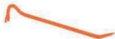
Figura 59 - Palanca para desencofrar.
