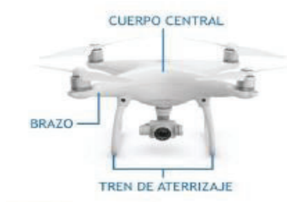
Imagen 13. Elementos estructurales de un dron de tipo multirrotores. [25]
