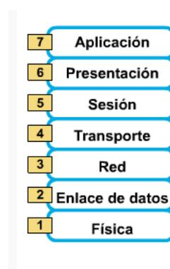
Figura 2. Capas modelo OSI
