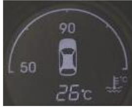
Figura 50. Temperatura exterior y del líquido refrigerante
