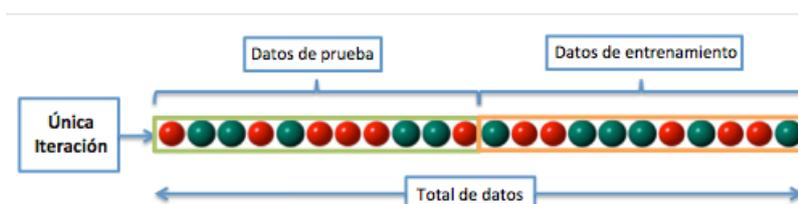
Figura 4.2. Mecánica de funcionamiento del método hold-out.
