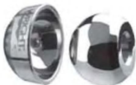
**Figura 33.** Par tipo metal-metal.
