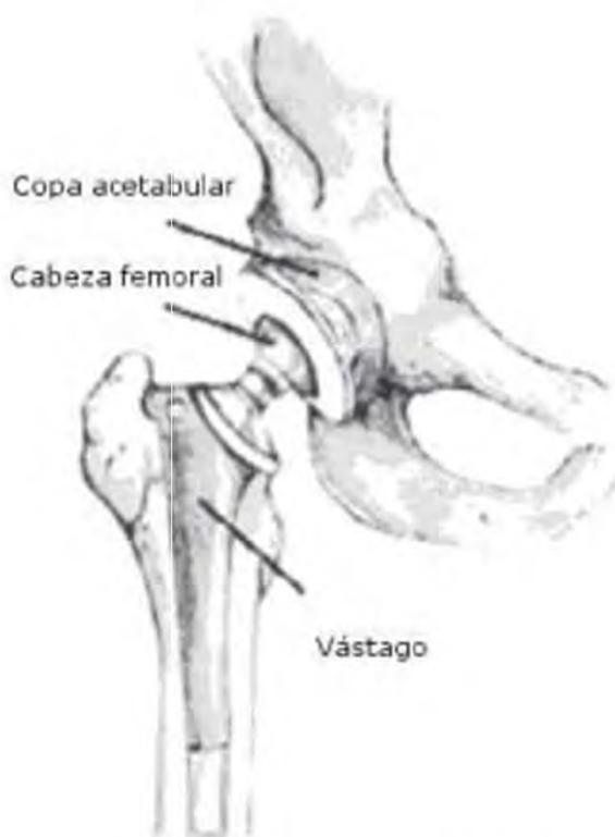
**Figura 14.** Implante protésico de cadera consistente en una copa acetabular fijada en el acetábulo de la pelvis, una cabeza femoral en fricción con el cotilo y un vástago femoral inserto en el canal femoral y que sustenta la cabeza femoral.
