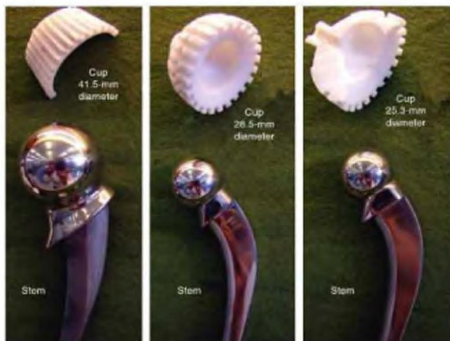
**Figura 32.** Diseños de Charnely en implantes de PTFE (Politetrafluoroetileno, comúnmente teflón).
