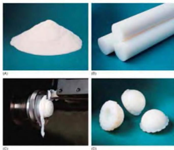
**Figura 56.** Fases del proceso de fabricación del cotilo UHMWPE.
