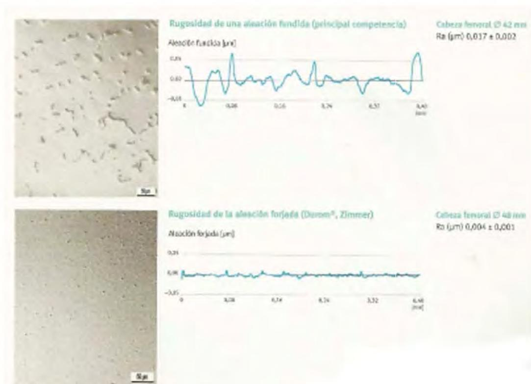
**Figura 36.** Rugosidad de aleación CoCr fundida frente a forjada.
