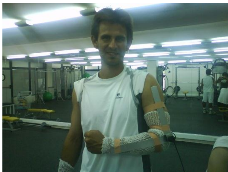
Imagen: sujeción del sensor angular Electro-goniometer en la articulación de codo (MuscleLab-Ergotest Technology, versión V7.18)
