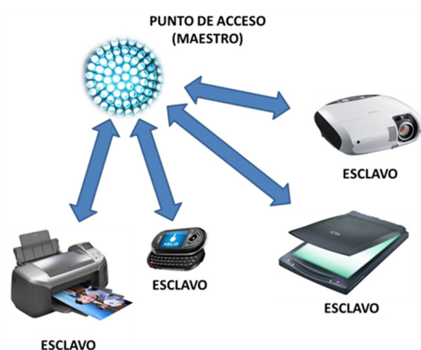
Figura 4-6. Red de datos centralizada en la que el punto de acceso transmite constantemente el piloto de sincronismo.
