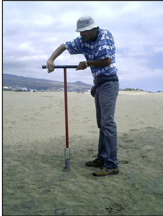
Figura 3.11. Utilización de la barrena manual.
