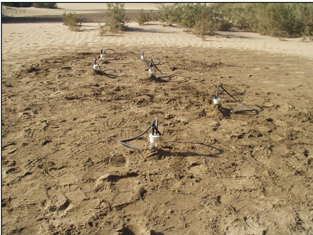
Figura 3.16. Detalle de una de las zonas muestreadas y de los lisímetros utilizados.
