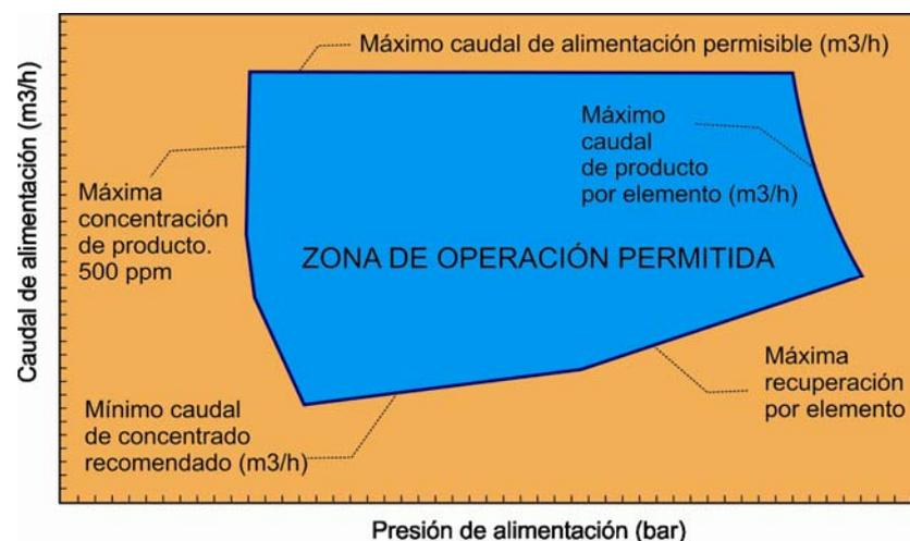
Figura 7.2. Rango de operación de un módulo de ósmosis inversa.
