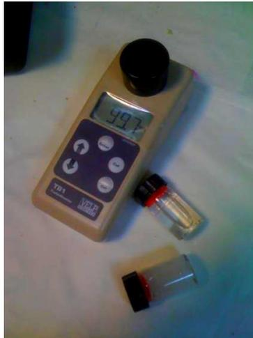
**Figura 12.** Turbidímetro TB1 de VELP Scientifica
