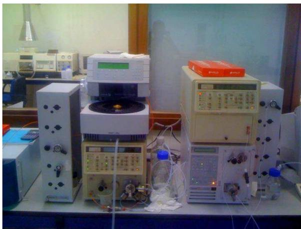
**Figura 4.** *Cromatógrafos de Líquidos de Alta Resolución*
