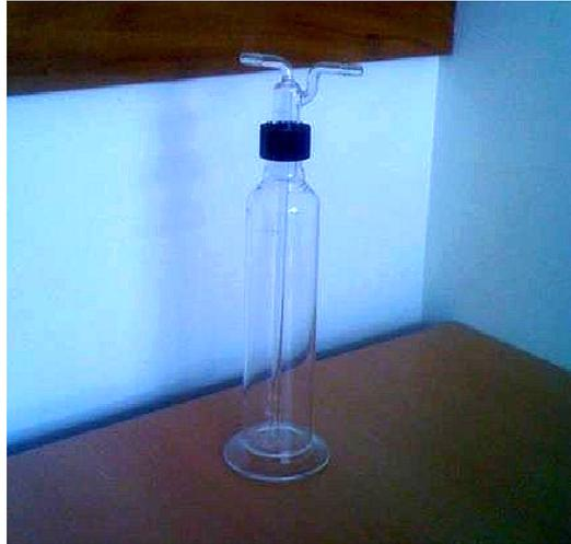
**Figura 9.** Reactor fotocatalítica
