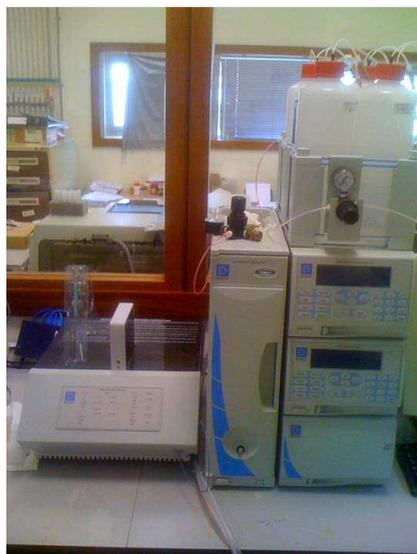
**Figura 5.** Cromatógrafo Iónico Dionex
