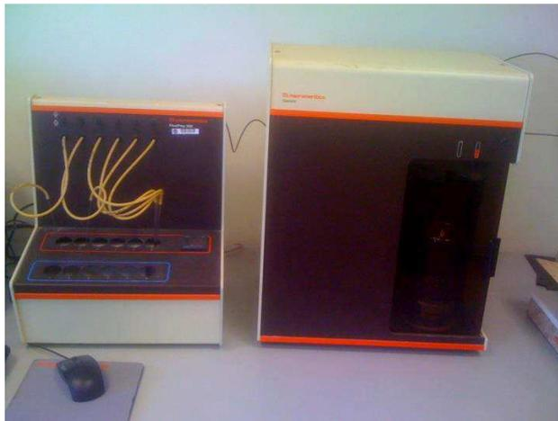
**Figura 3.** Analizador Micromeritics Gemini III 2375
