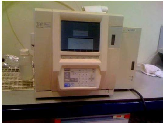
**Figura 6.** Analizador de carbono orgánico total (Shimadzu TOC-V<sub>SCN</sub>)
