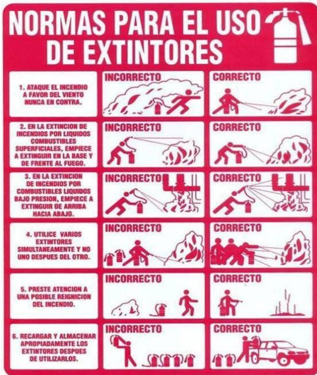
FIGURA 32. UTILIZACIÓN DEL EXTINTOR.
