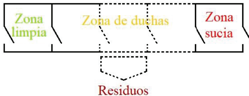
Ilustración 6 - Compartimentos de las unidades de descontaminación
