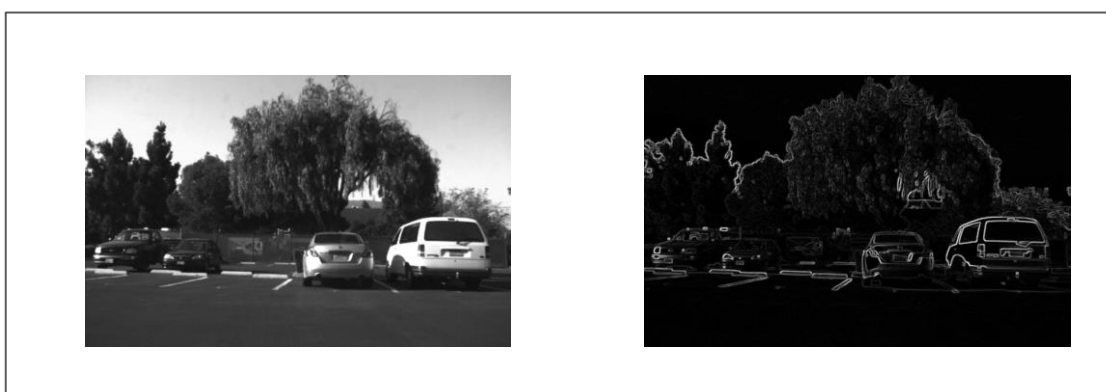
Figura 4.1. Resultado de la ejecución del test bench mlhdlc_sobelfilter_tb.m
