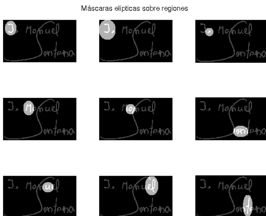
Figura 2.6: Proceso de enmascaramiento con elipses
