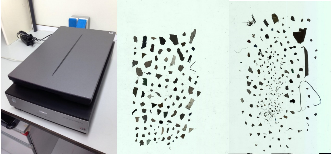
Fig. 4: Ejemplos de imágenes obtenida con Epson perfection V800 a partir de una muestra de residuos plásticos (MCA.2016-06-06.c y MCA.2016-05-10.a).
