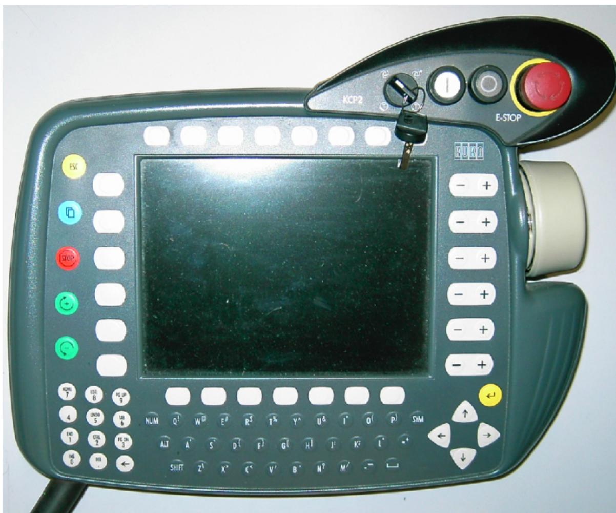
Figura 1.2: Panel de control remoto del robot KUKA KR 16.
