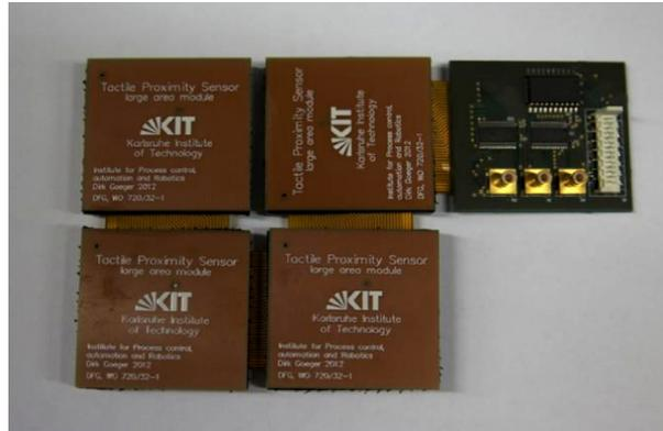
Figura 1.6: Electrónica necesaria para la configuración de una pinza de 4 sensores monocanal.
