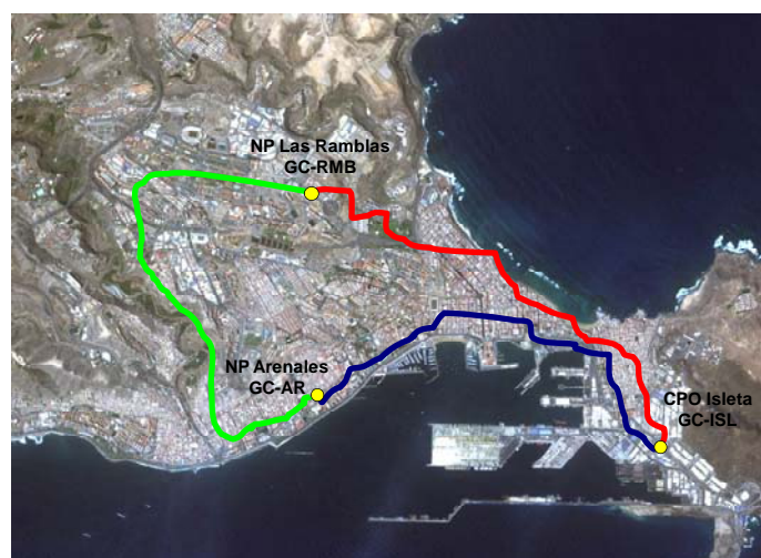
Figura 3.7: Anillo troncal de fibras de Las Palmas de Gran Canaria
