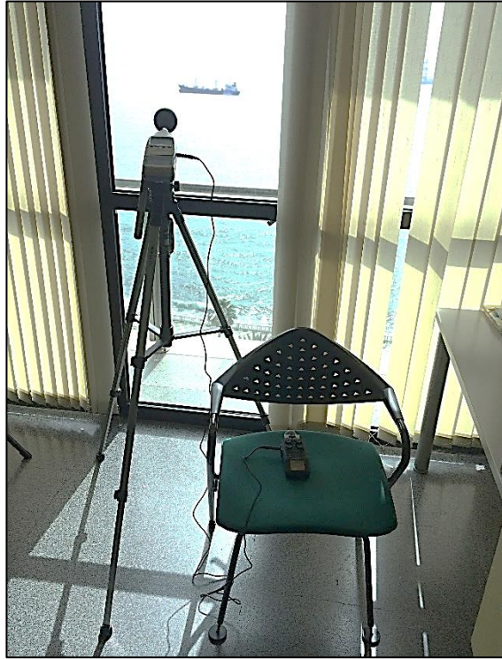
Figura 5.5.- Conexión sonómetro - grabador
