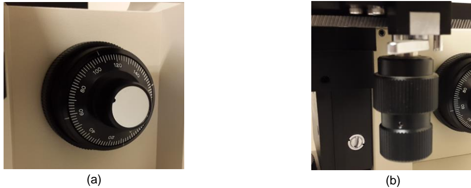
Figura 3-12: Mandos de enfoque microscopio. (a) eje Z (b) ejes X e Y
