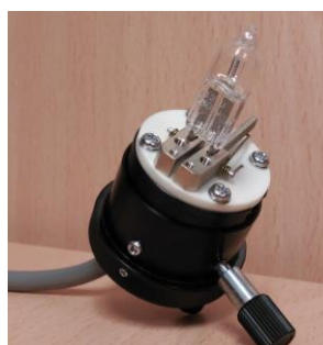
Figura 3-15: Lámpara halógena del microscopio.
