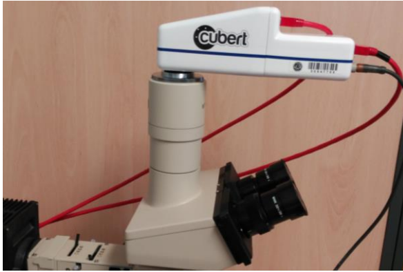
Figura 3-16: Cámara hiperespectral + microscopio.
