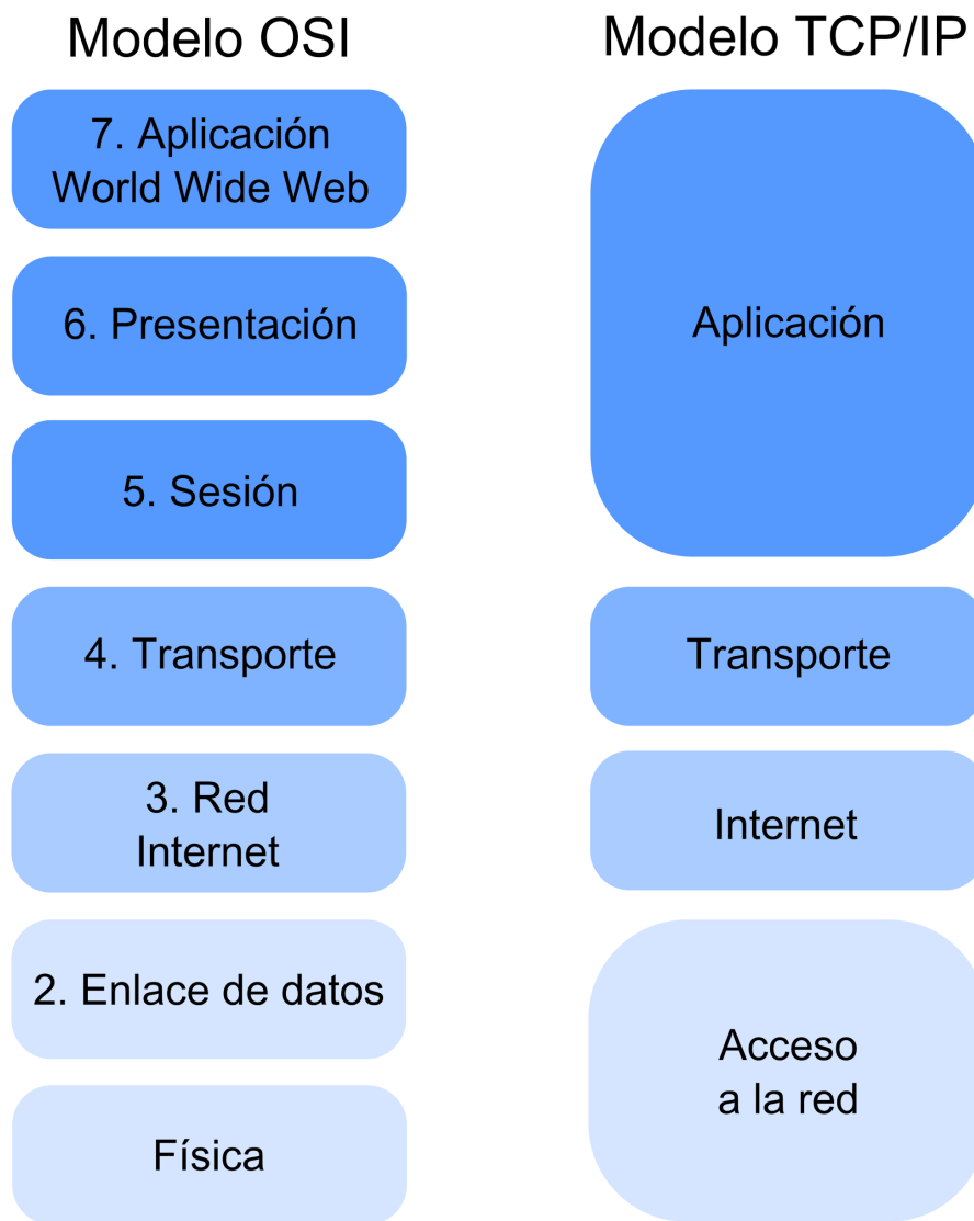
Figura 3: Modelo 7 capas OSI, modelo 4 capas TCP/IP.
