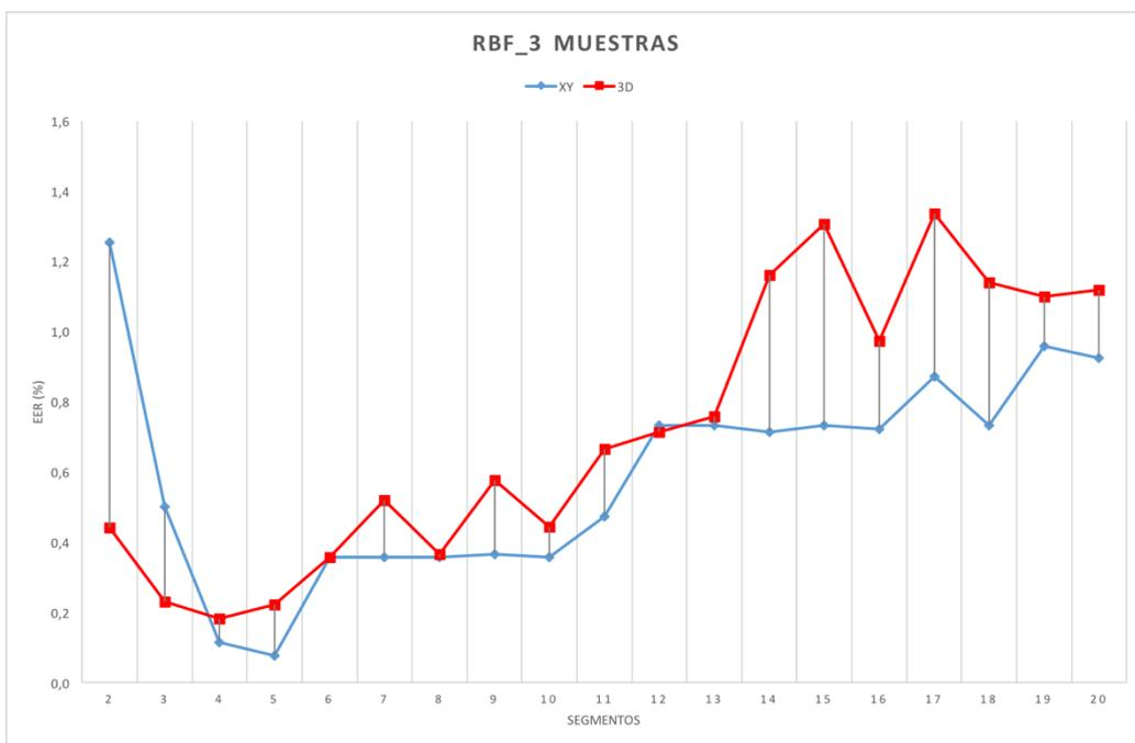
Figura 5.17. Comparación de los planos XY y XYZ, usando *kernel* RBF y 3 muestras de entrenamiento.
