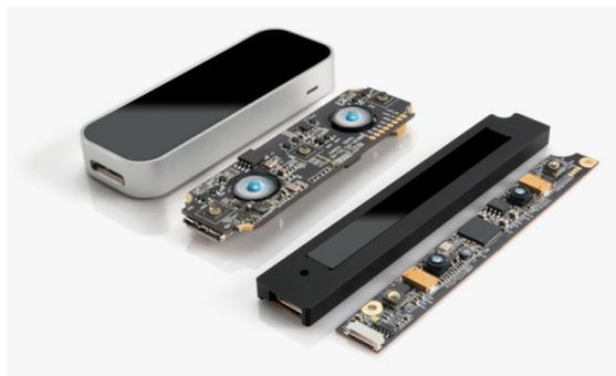
Figura 1.4. Interior de Leap Motion, donde se observan las cámaras de infrarrojo
