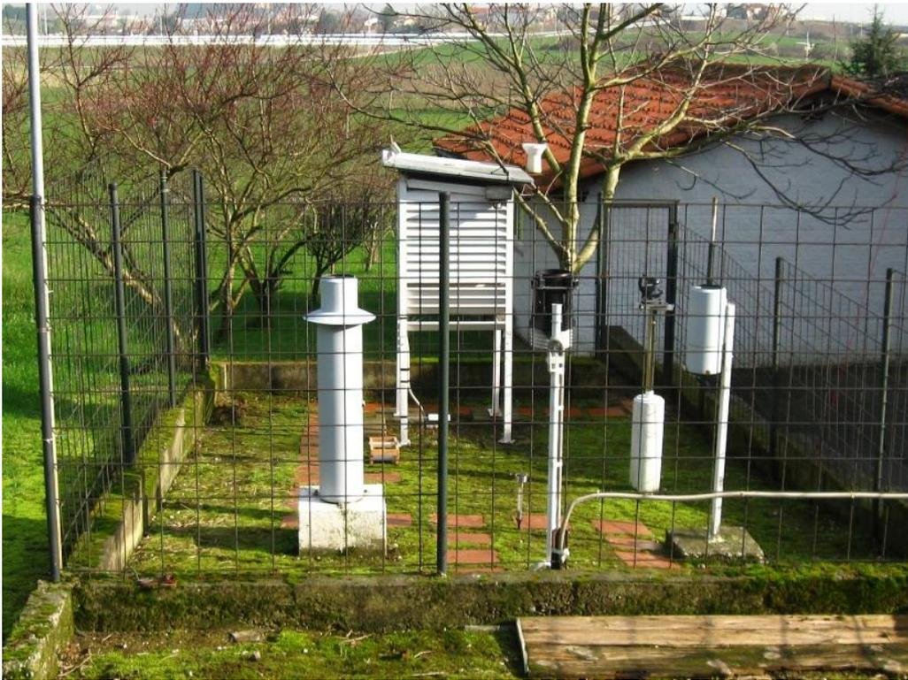
Fig. 4-1. Imagen de una estación meteorológica estándar de AEMET
