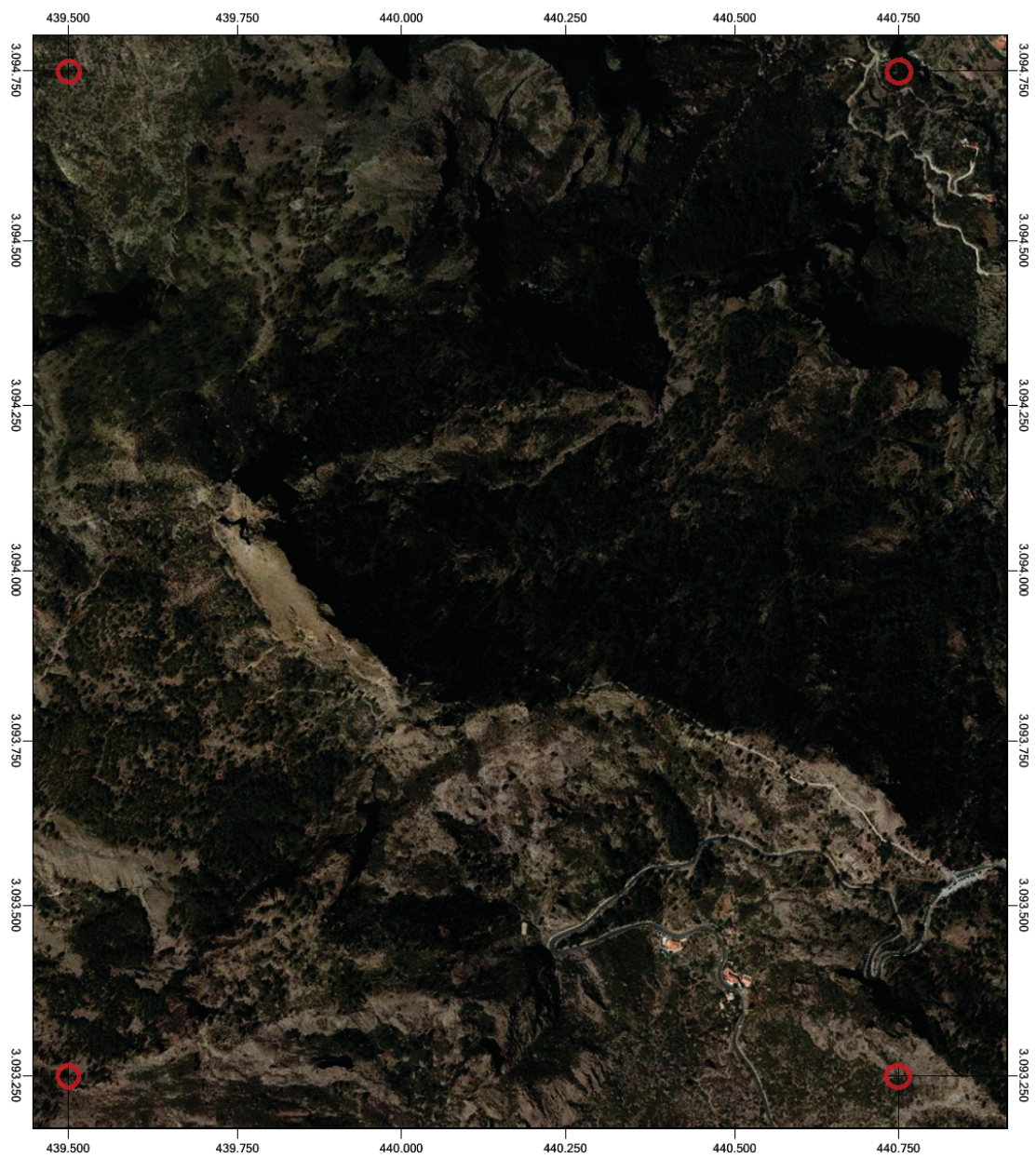
Figura I.39: Representación de los cuatro puntos necesarios para georreferenciar una imagen con QGIS
