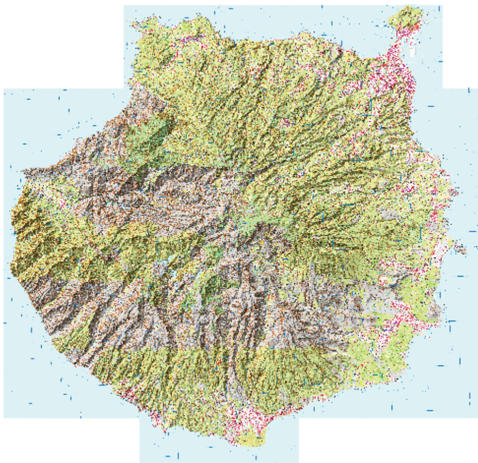
Figura I.66: Representación del resultado de aplicar el comando gdal_merge al mapa de líneas isométricas de la isla de Gran Canaria
