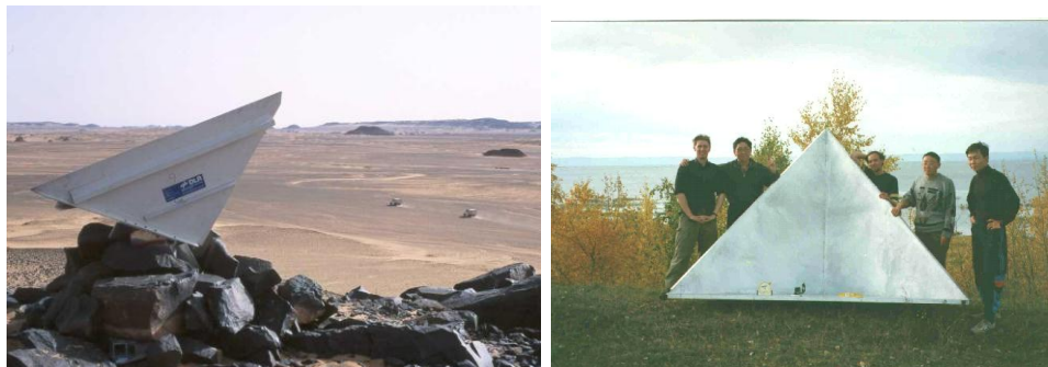
Figura 3.4. Reflectores de calibración en tierra para sensores SAR [58].
