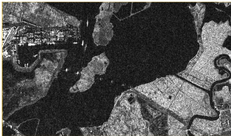
Figura 3.17. Imagen SAR calibrada y filtrada con Refined Lee polarimétrico, canal HV. Ventana de 7x7.
