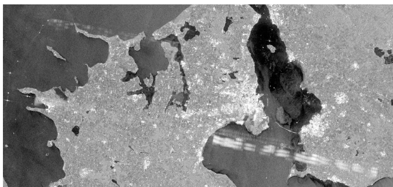
Figura 3.22. Radio interferencias (RFIs) al sur de la ciudad de Copenhague. Producto EW GRDM Sentinel-1A (fecha de la imagen, 21/01/2016).
