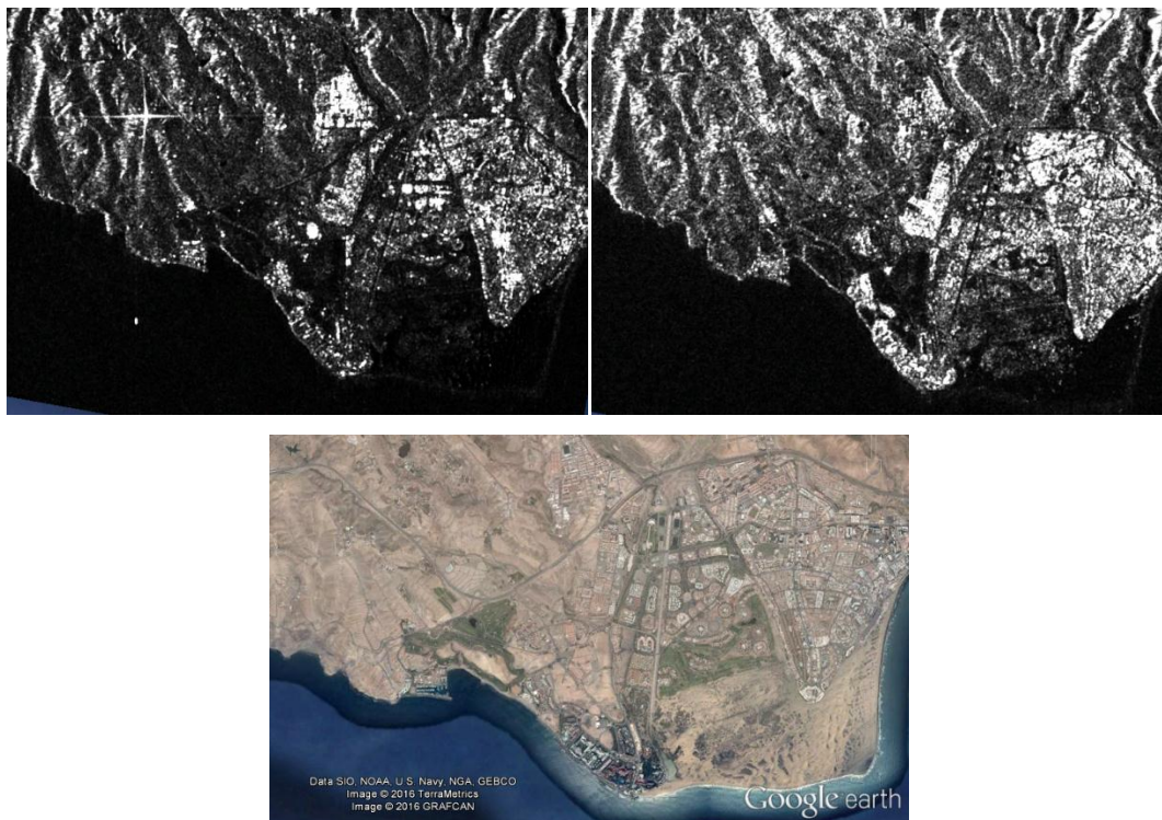
Figura 3.19. Las imágenes superiores corresponden a un producto SLC IW del Sentinel-1A del sur de Gran Canaria (fecha de la imágenes, 05/09/2015). El producto ha sido calibrado, se le ha aplicado el filtrado de Speckle y ha sido ortorectificado. Arriba a la izquierda, canal VV. A la derecha, canal VH. Se observa el reflejo de las antenas del Centro Espacial de Canarias en el canal VV, mientras que en el canal VH, el nivel de backscattering es similar al de la zona que lo rodea. Abajo, imagen óptica de GRAFCAN disponible en Google Earth® (fecha de la imagen 03/04/2015).
