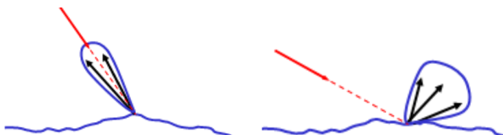
Figura 3.3. Ilustración sobre la orientación del backscattering en función de la superficie iluminada. A la izquierda, reflejo orientado de vuelta hacia el sensor. En la derecha, reflejo orientado alejándose del sensor.
