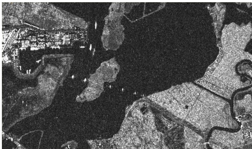
Figura 3.16. Imagen SAR calibrada y filtrada con Refined Lee simple, canal HV.
