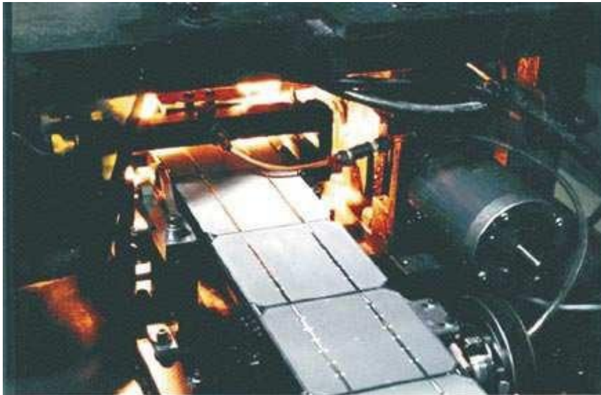
Fig. 1.7. Proceso de soldadura de la rejilla metálica durante el ensamblaje del panel.
