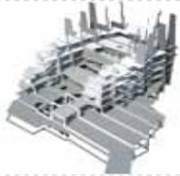
Se ha realizado una modelización de la estructura utilizando el programa de cálculo "CYPECAD", de la cual se obtienen los siguientes datos.
