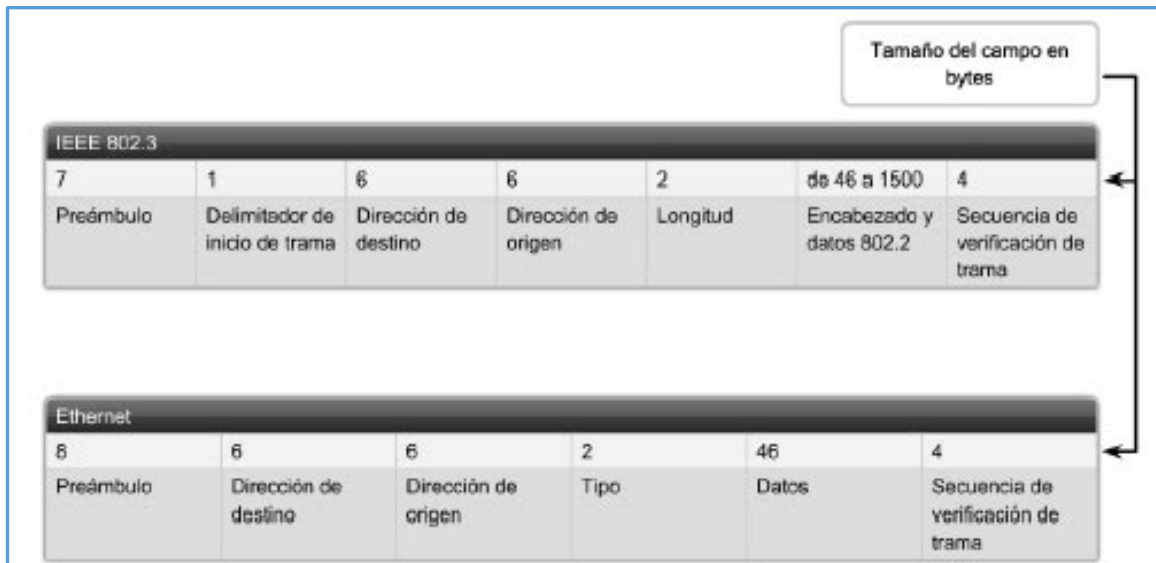
Ilustración 3.2 Comparativa de los campos de la trama Ethernet y IEEE 802.
