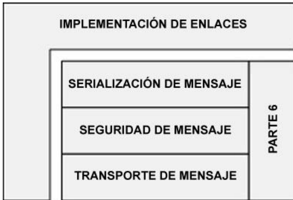
Ilustración 2.12 Capas de la pila de comunicación UA definida en la parte 6
