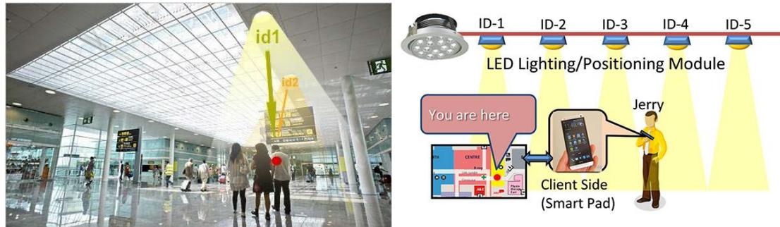
Figura 2.3. VLC para aplicaciones de localización en interiores.
