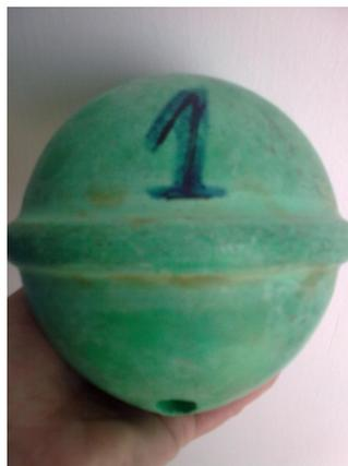
Figura 4.6: La flotabilidad de la instrumentación es proporcionada por una pareja de boyas como la mostrada en esta imagen.
