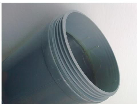
Figura 4.10: Detalle del complemento roscado en la parte inferior del contenedor que actúa como sistema de anclaje. Se puede apreciar la separación de la base que mantendrá el contenedor estanco por la parte inferior.
