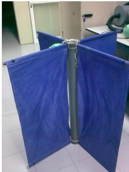
Figura 4.5: Derivador desplegado tipo CODE utilizado en este proyecto.
