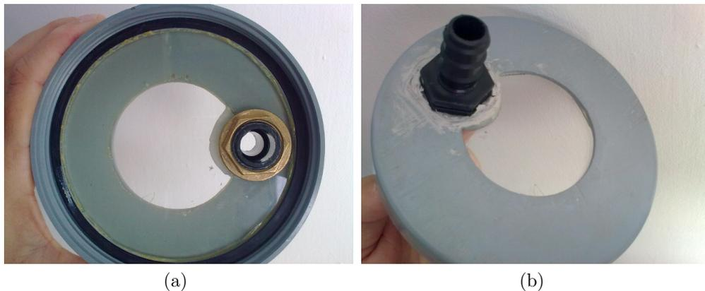
Figura 4.8: Detalles de las modificaciones hechas en la tapa de cierre del contenedor.
