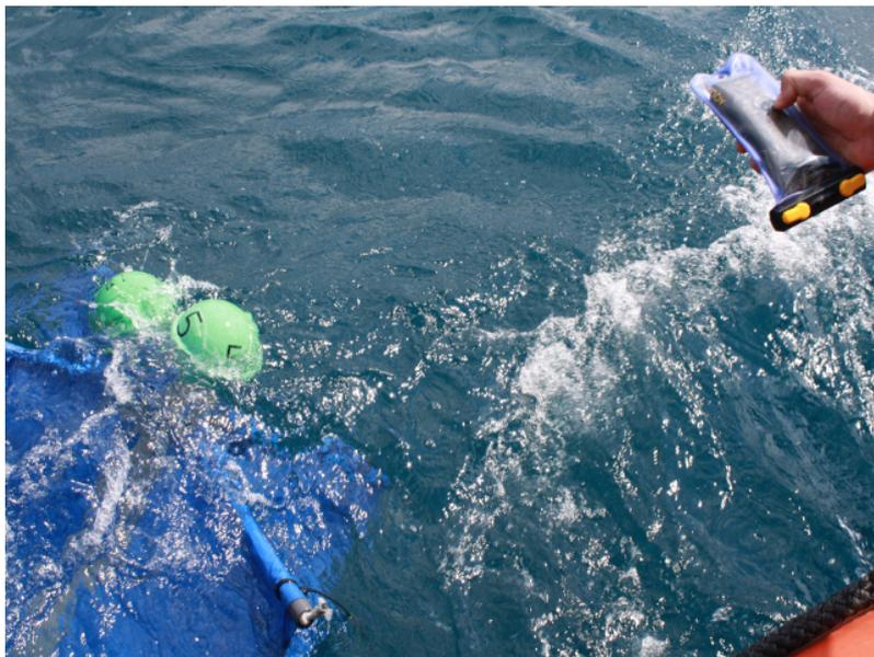
Figura 1.3: Marcado manual de posición del derivador con GPS.
