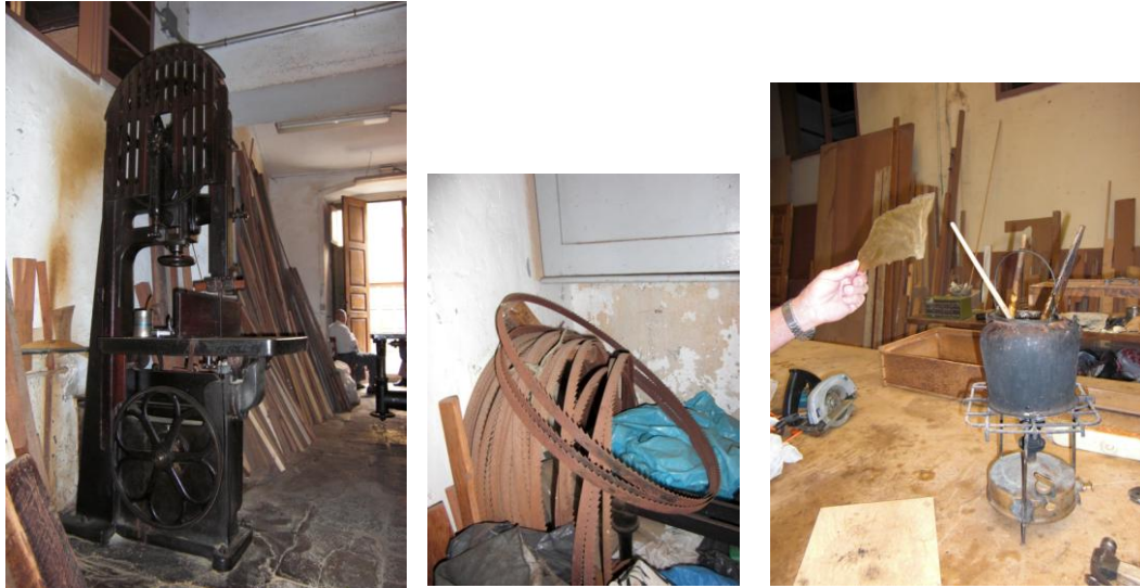
Carpintería de los Clemente, calle López Botas, Vegueta. Máquina Sinfín (1950), permite serrar tanto en recto como en volteo. La forma de la sierra (centro) es redonda, de ahí su nombre, sinfín, porque la sierra gira sin parar. Los Clemente siguen fabricando su propio pegue poniendo lámina de cola al baño maría en la “cafetera” (dcha.), 2009. Fuente: la autora.
