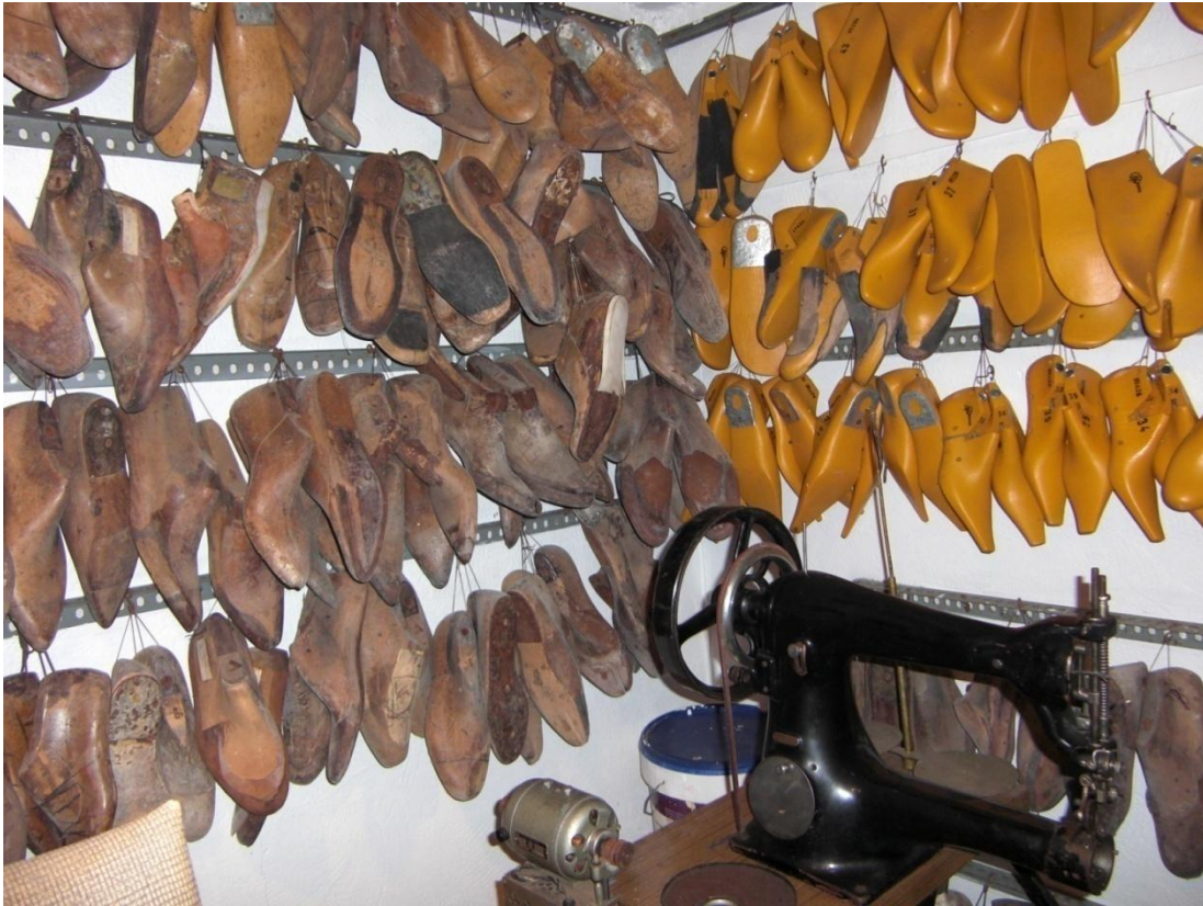
Hormas de madera (izquierda) y hormas de resina (derecha) para la fabricación de calzado a medida, 2009. Ambas son utilizadas actualmente en el taller. La máquina de coser es una cilíndrica auxiliar. Fuente: la autora.
