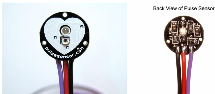
Figura 18. Vista frontal y trasera del Pulse Sensor
