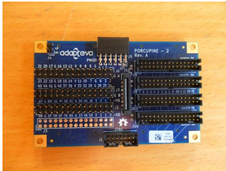
Figura 2.11. Placa Porcupine – Conectores externos
