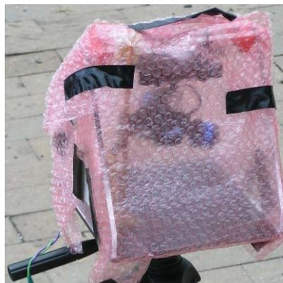
Figura 4.11. Aislamiento de la IMU del viento
