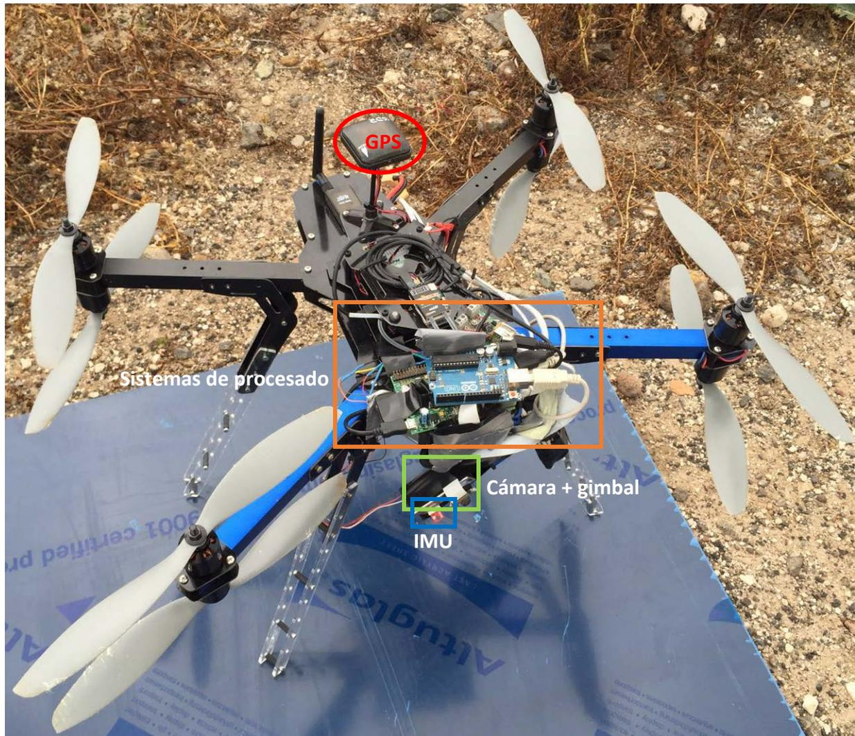
Figura 5.22. Sistema montado en dron
