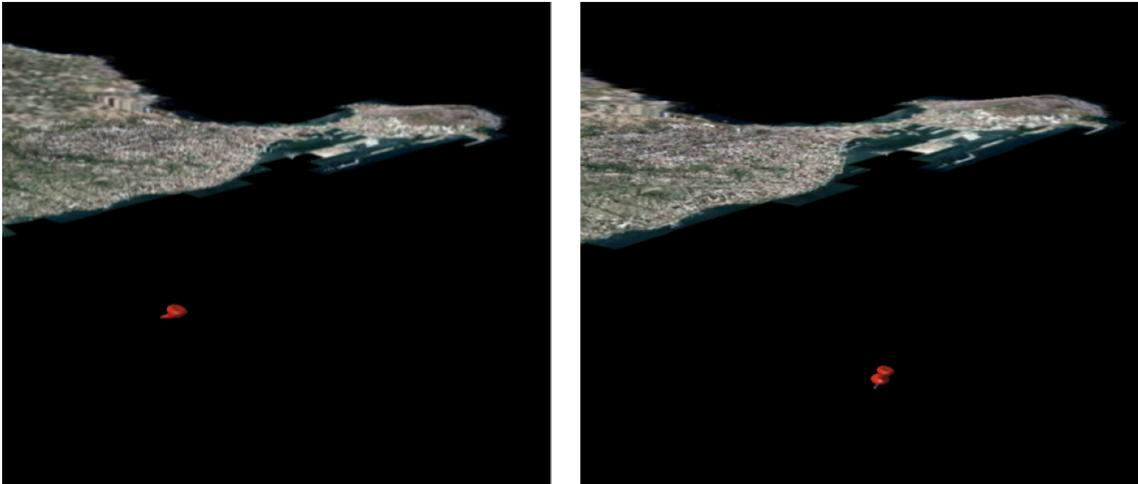
Figura 36 - Marca renderizada con y sin test de profundidad
