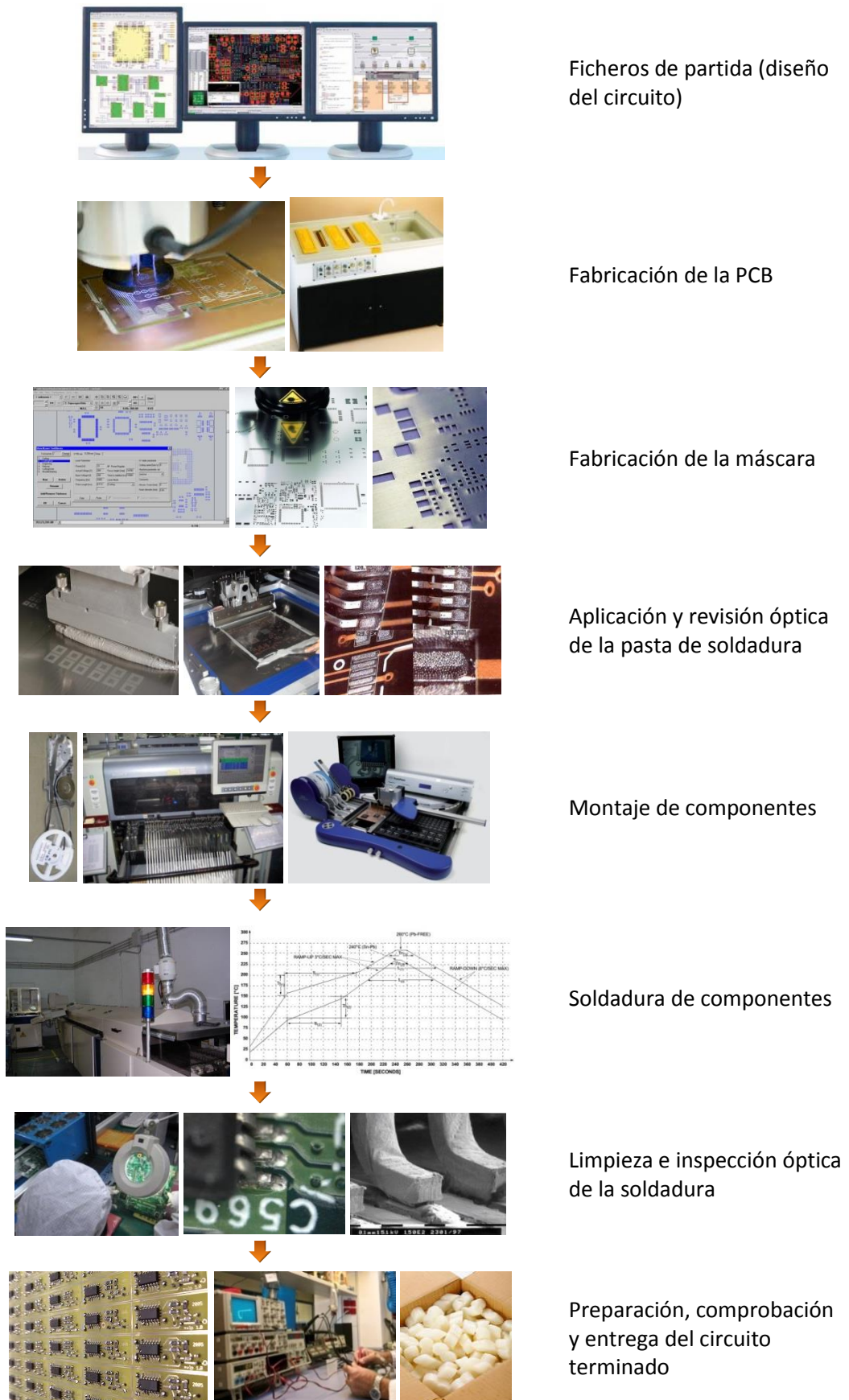
Figura 1. Diagrama del proceso de fabricación de PCB en el laboratorio.
