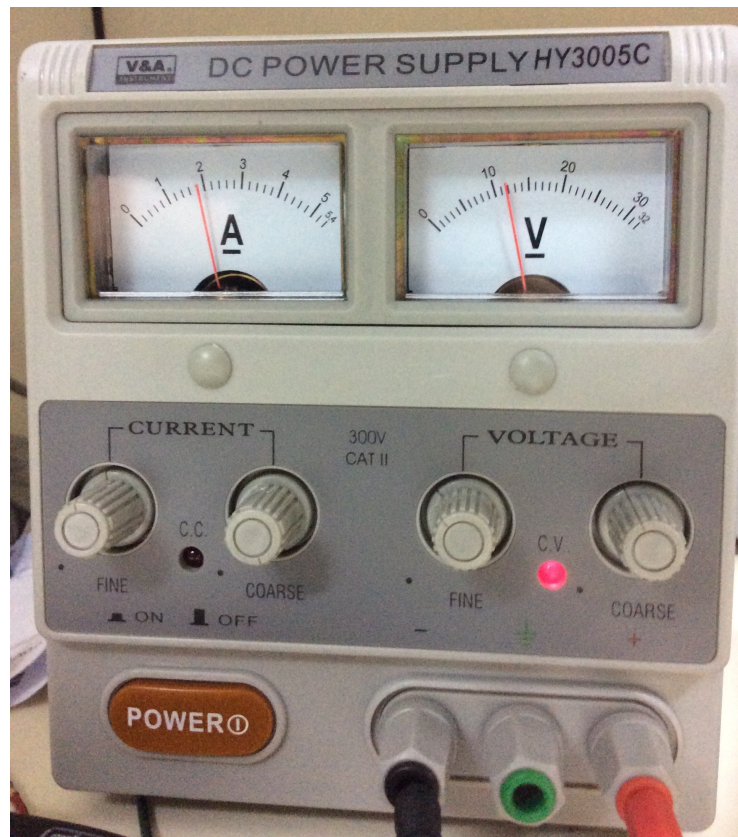
Figura 8.8: Tensión y corriente de entrada suministrada por la fuente en el punto de máxima tensión de salida.
