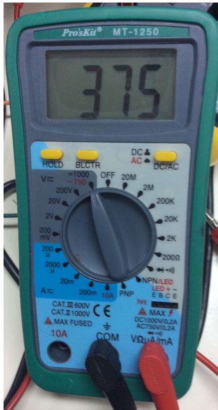
Figura 8.7: Tensión medida en el condensador C1 con un ciclo de trabajo del 50 %
