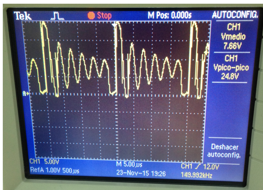
Figura 8.9: Tensión oscilante en el drenador del MOSFET
