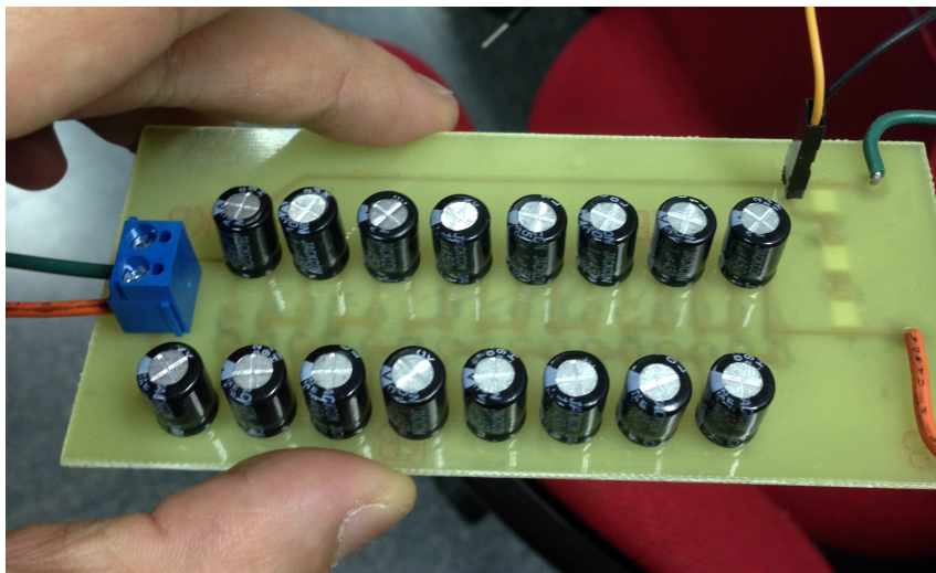
Figura 7.3: Resultado de la soldadura de componentes de inserción en la etapa CW
