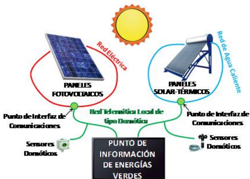
Figura 5.1 Esquema de las instalaciones utilizadas en el proyecto PIVE
