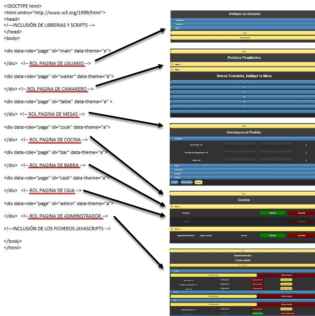
Figura 6-1-1. Estructura HTML y su correspondencia con las pantallas.
