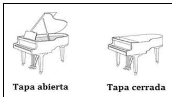
Figura 3.126. Posiciones de tapa abierta y tapa cerrada empleadas en el estudio de la directividad.
