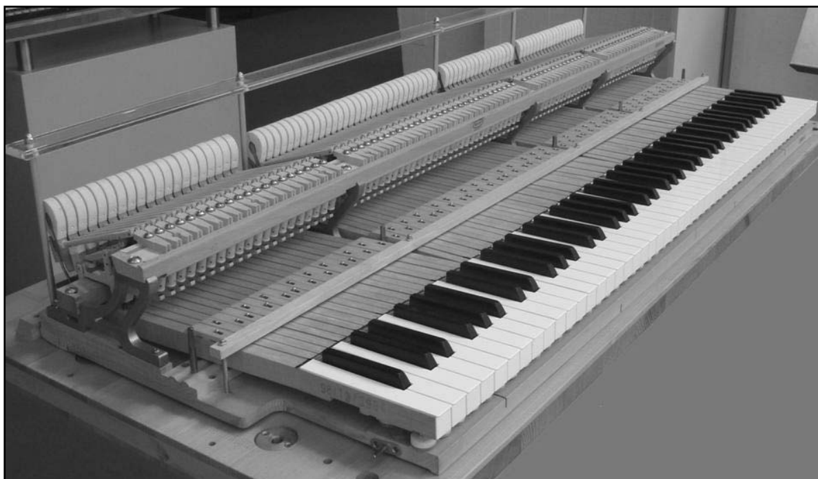
Figuras I.D.60. Teclado y mecanismo de percusión de un piano de cola actual [45].
