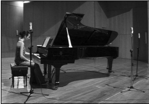
Figura 3.127. Grabación de las muestras sonoras necesarias para el estudio de la directividad en condiciones de tapa abierta.
