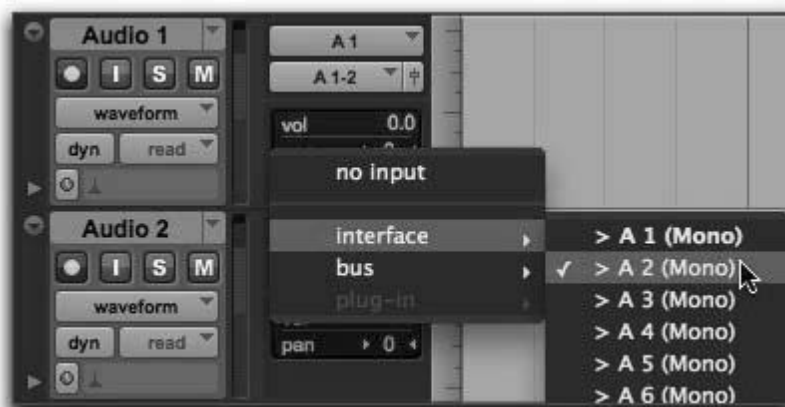
Figura 2.94. Asignación de entrada a una pista de audio en Pro Tools® LE 8.
