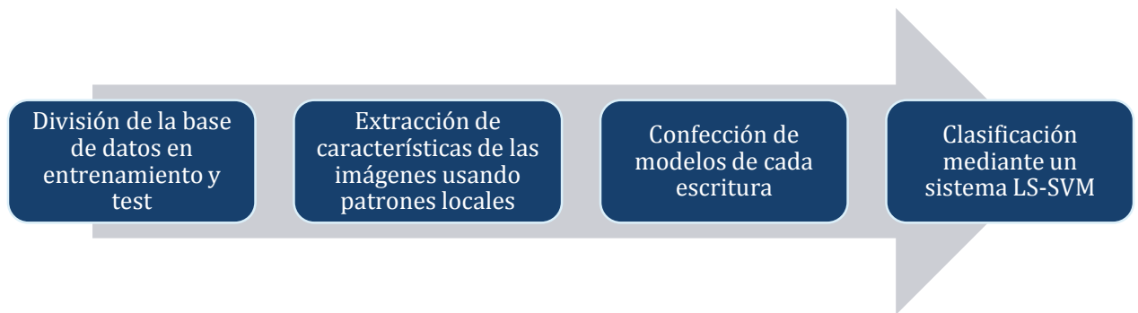
Figura 46. Esquema general del funcionamiento del sistema de reconocimiento del tipo de escritura
