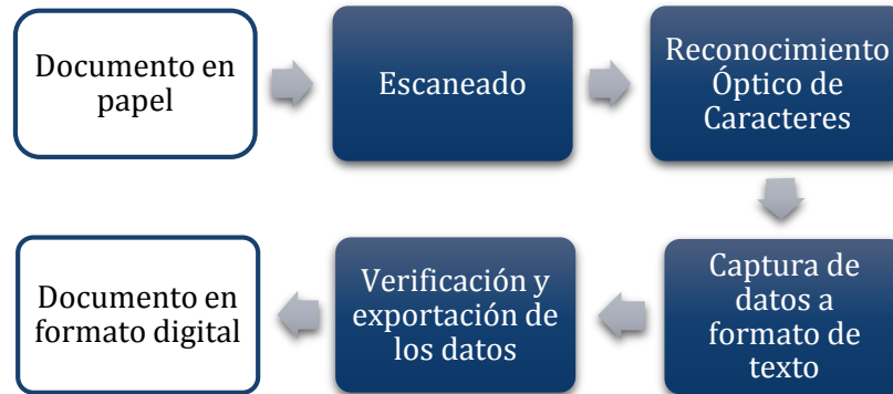
Figura 2. Flujo de trabajo de un OCR.
