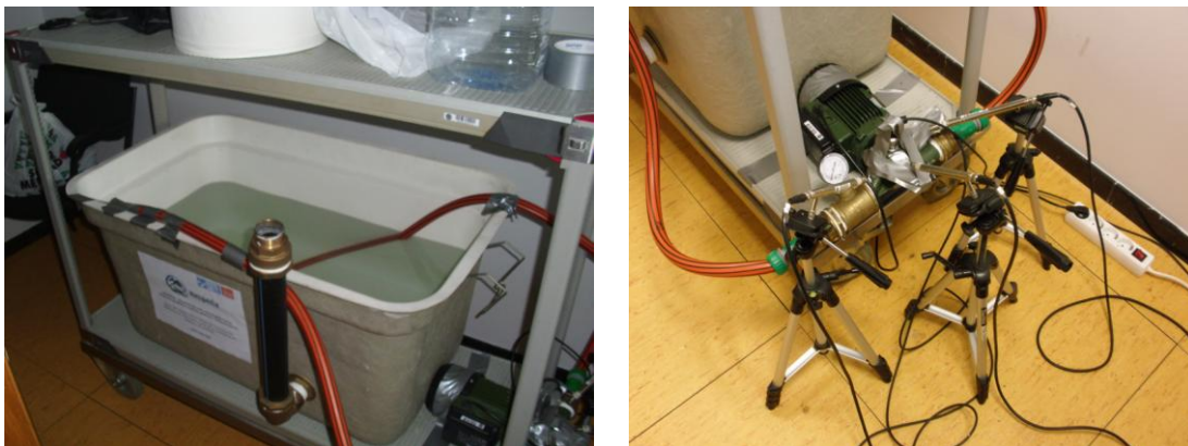
Figura 51: Tanque de experimentación. Bomba de experimentación y sensores.
