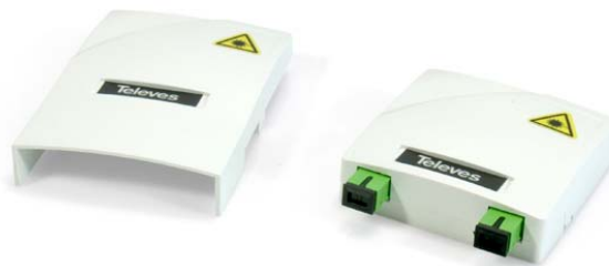
FIGURA 19. PAU de F.O. hasta 2 adaptadores SC-Hembra (incluidos) Ref. 2315. Medidas (Ancho x Alto x Profundidad): 80 x 80 x 25 mm.
