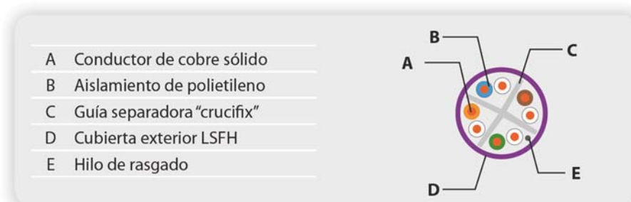
FIGURA 9. Características constructivas del cable UTP.
