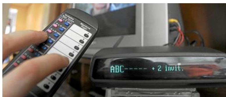
Figura 3.1. Audímetro y control remoto
